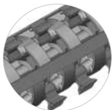
Rotor optionnel avec marteaux mobiles pour broyer les buissons et le bois
